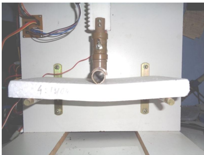
Figura 31 – Corpo de prova posicionado sobre os apoios submetido atuação do avanço do cutelo.
