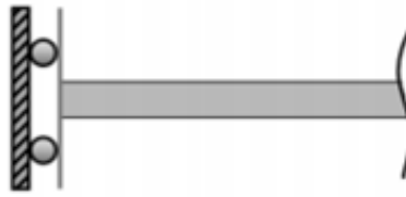
Figura 23 – Placa com borda deslizante em x = a com vistas lateral e superior (ABREU, 2012).
